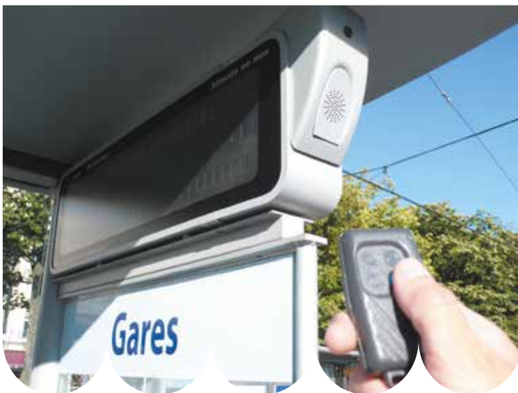
Borne d'information voyageurs équipée d'une technologie adaptée aux usagers aveugles ou malvoyants © SMTC
