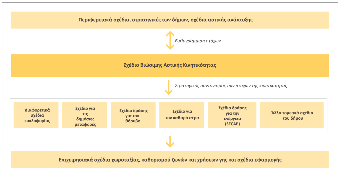
Σχήμα 3: Δομή των σχέσεων μεταξύ του ΣΒΑΚ και άλλων σχεδίων (προσαρμοσμένη από τον Ahrens et al., FGSV 2015, Recommendations for Mobility Master Planning, σ. 8)
